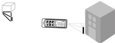
Le mode double mesure pythagoricienne inversée permet de calculer la distance entre trois points mesurés, la dernière mesure étant effectuée selon un angle de  $90^\circ$ .
