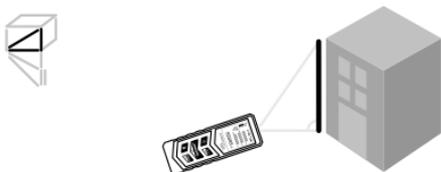
Le mode mesure indirecte permet de calculer la distance entre deux points mesurés, la seconde mesure étant effectuée selon un angle de  $90^\circ$  par rapport à la première.
